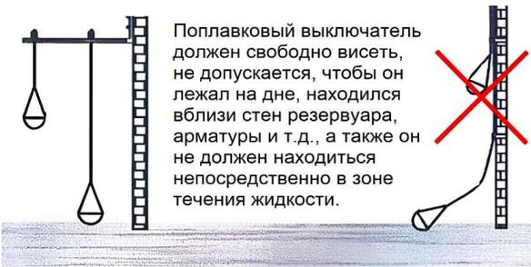
Поплавковый выключатель должен свободно висеть, не допускается, чтобы он лежал на дне, находился вблизи стен резервуара, арматуры и т.д., а также он не должен находиться непосредственно в зоне течения жидкости.
